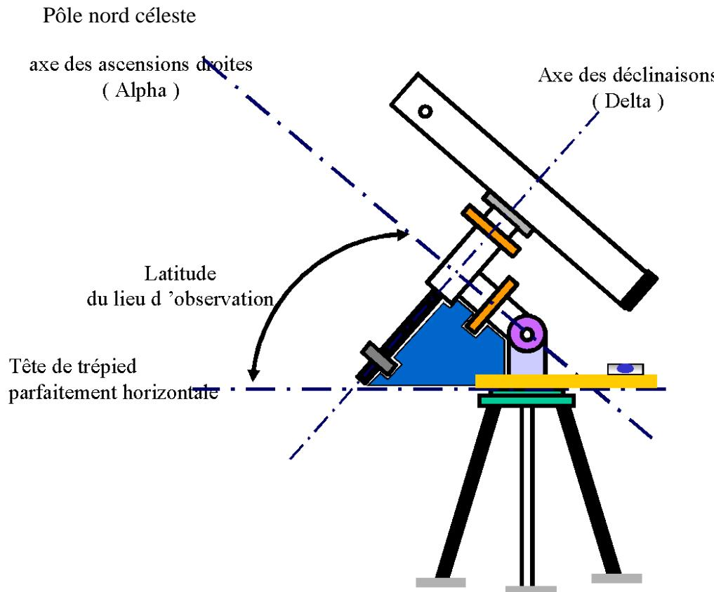
La mise en station consiste à diriger l'axe des ascensions droites en direction du pôle nord céleste, autrement dit, de placer cet axe parfaitement parallèle à l'axe des pôles nord-sud de la Terre.
