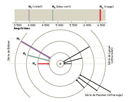
Sachant que les électrons composant un atome tournent autour du noyau, Niels Bohr a imaginé au début de XXème siècle que les orbites des électrons ne pouvaient se trouver qu'à des endroits précis, à des distances déterminées du noyau, un peu à l'image d'une échelle, où les pieds (les électrons) ne peuvent se poser que sur les barreaux (les niveaux d'énergie).
