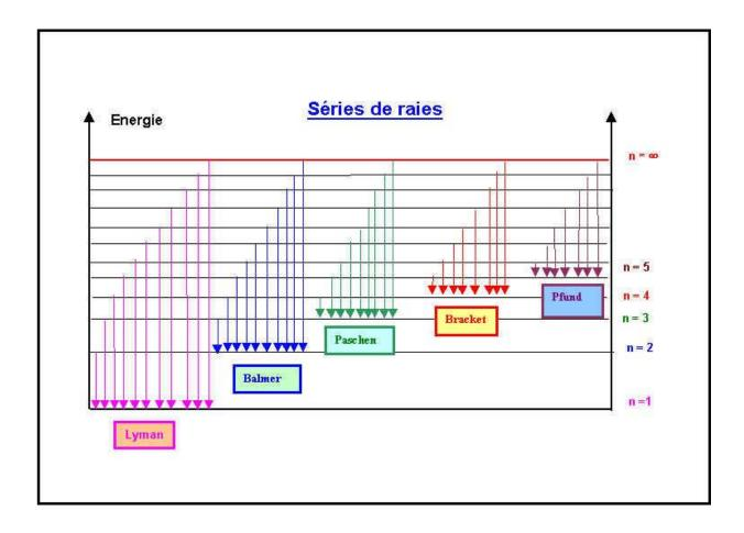
Les raies de Lyman sont dans Ultraviolet, celles de Balmer dans le visible (elles contiennent pour l'hydrogène les célèbres raies  $H\alpha$ ,  $H\beta$ ,  $H\gamma$ ,...). Les autres séries sont dans l'infrarouge.
