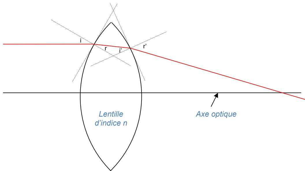
Le rayon lumineux arrivant sur la lentille avec un angle  $i$  par rapport à la normale de la tangente en ce point, poursuit son chemin dans le verre d'indice  $n$ , et est réfracté une seconde fois en sortant du verre avec un angle  $r'$ , encore par rapport à la normale de la tangente au point de sortie.
