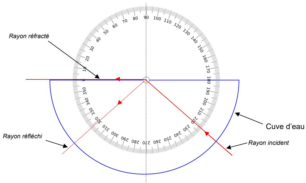
Mesurer l'angle de réflexion totale permet aussi de mesurer les indices de réfraction. C'est la méthode utilisée dans les réfractomètres.
