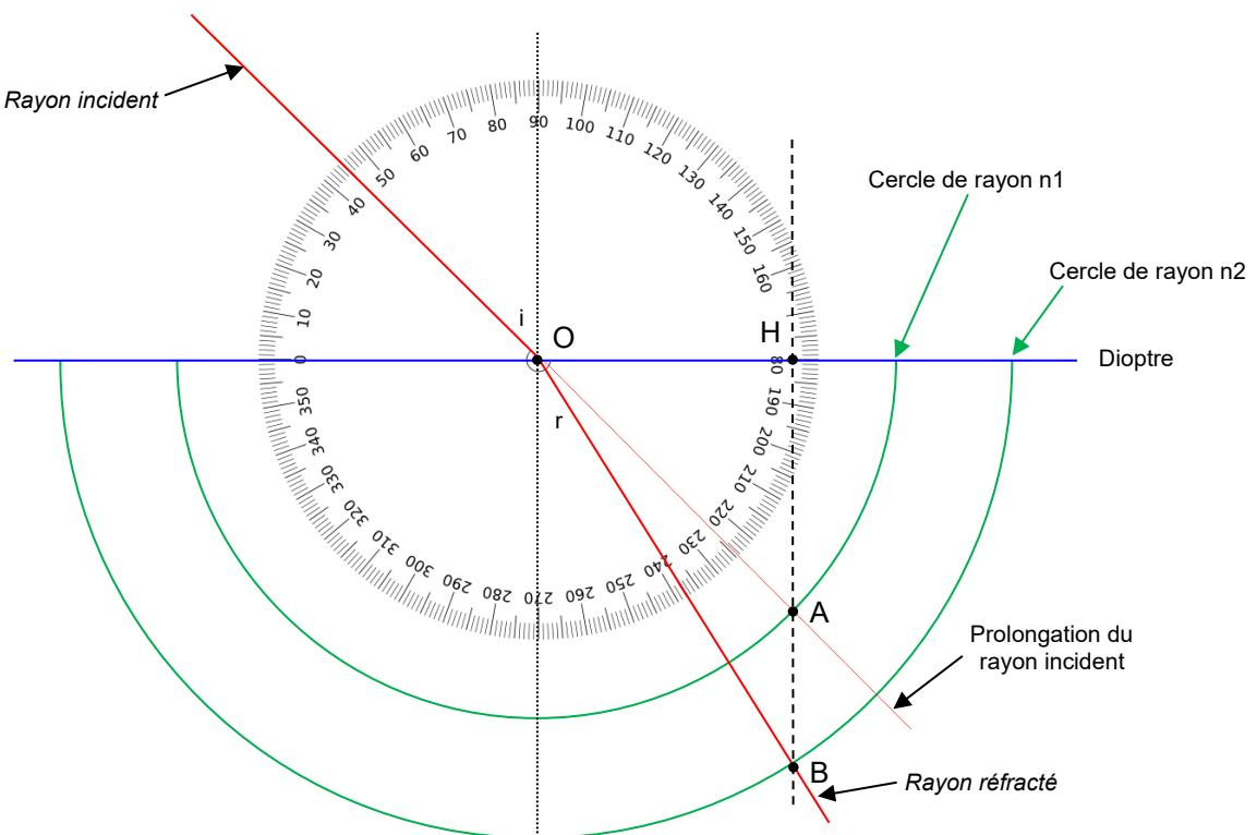
A partir du point O, passage du rayon incident du milieu 1 au milieu 2, on trace deux cercles de rayon respectivement proportionnels à n<sub>1</sub> et n<sub>2</sub>.
