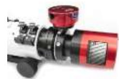
Le guidage peut avantageusement être fait à l'aide d'une seconde caméra CCD ou d'une webcam, dont le logiciel assurera le suivi correct par des actions contrôlées sur les moteurs de la monture. C'est l'autoguidage, qui tend à se généraliser.
